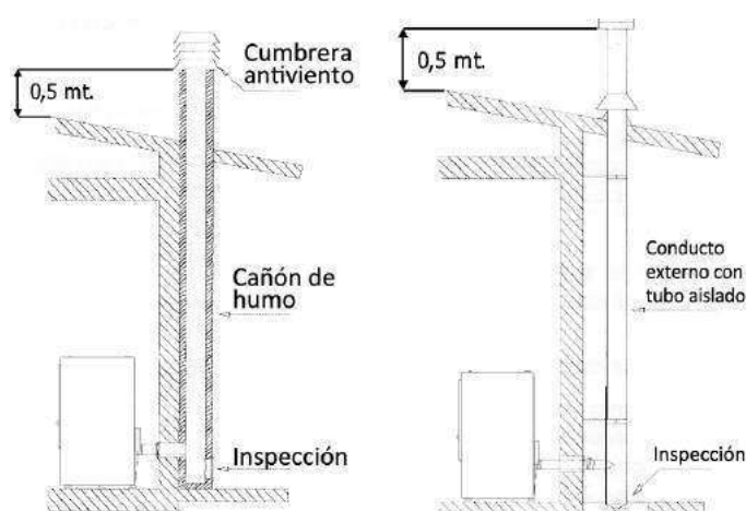
Fig. 2: conexión con el cañón de humo
