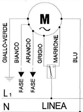
Il servomotore delle valvole motorizzate **VS22x** e **VS23x** è del tipo con comando a 3 punti ed è munito di un cavo multipolare colorato per il collegamento elettrico che deve essere effettuato secondo lo schema allegato e a quanto sotto descritto:
