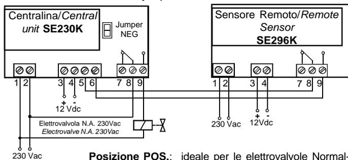
**Posizione POS.:** ideale per le elettrovalvole Normalmente Chiuse o per il controllo contemporaneo dell'elettrovalvola e di un carico elettrico esterno. **Position POS.:** Continuous charge suitable for Normally Closed electrovalves or for simultaneous control of a electrovalves and an external electric charge.
